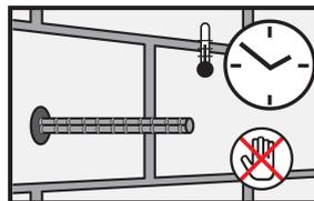
Durante el tiempo de endurecimiento de la resina el anclaje no debe moverse o ser sometido a carga. Esperar el tiempo indicado según la temperatura. Las herramientas deben ser limpiadas inmediatamente con Colma Limpieza. La piel debe ser lavada con agua tibia y jabón.
