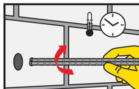
Insertar la barra o perno en el hueco girando levemente, siempre dentro del tiempo de "tacking", mientras el adhesivo se mantiene fresco. El anclaje debe ser colocado dentro del tiempo abierto (según tabla).
