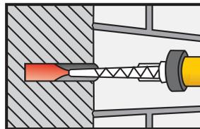
Injectar adhesivo en el fondo de la perforación y retirar lentamente el puntero a medida que el hueco se llena. Evitar la formación de burbujas de aire. Para perforaciones profundas puede usarse un tubo de extensión.
