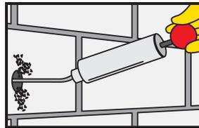
La perforación debe limpiarse mediante soplado (con bomba o sistema de aire comprimido), comenzando desde el fondo del orificio (al menos 2 veces). Importante: use compresores sin aceite.
