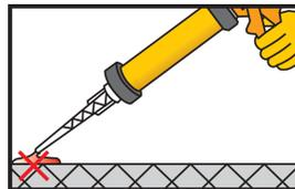
Presionar el gatillo de la pistola (aprox. 2 veces) hasta que se obtenga una consistencia y color uniforme del adhesivo; no usar este material.
